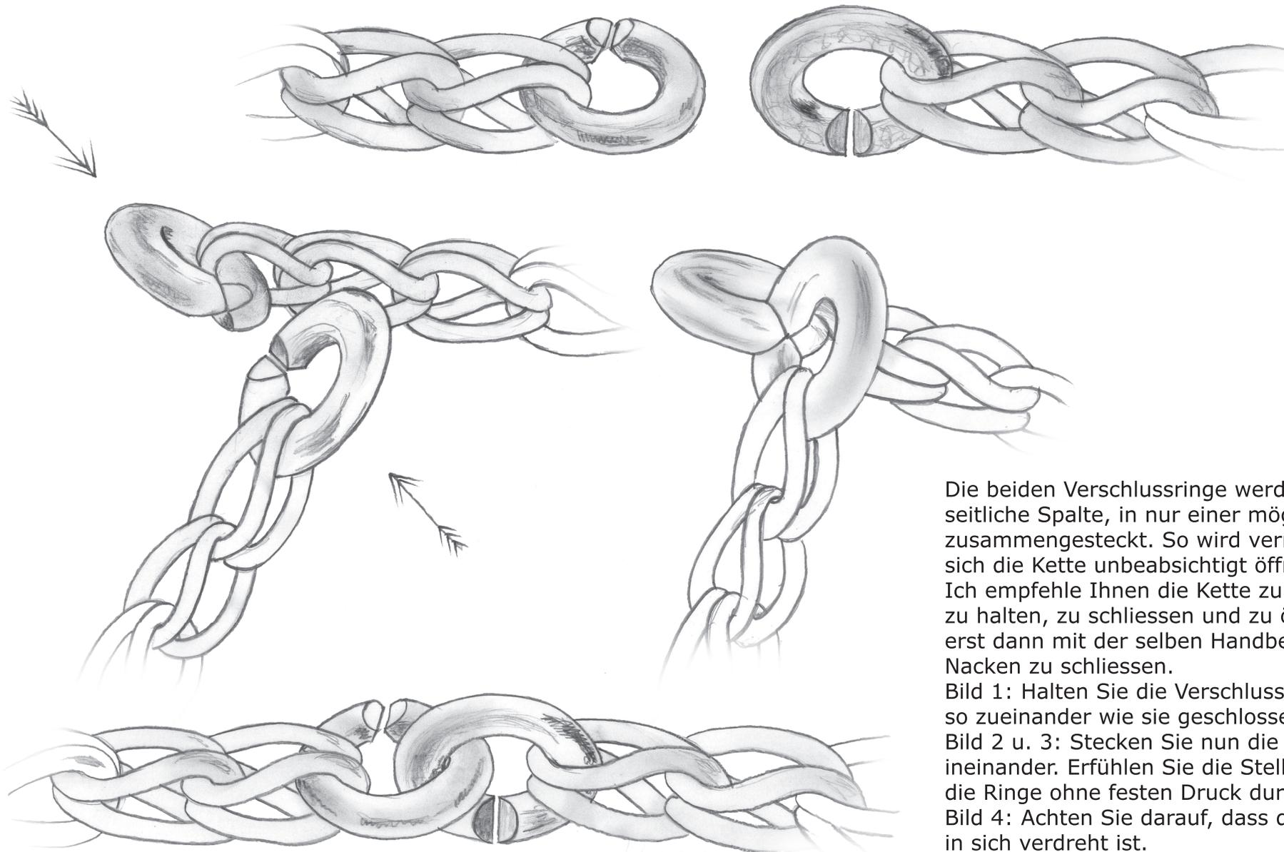
Die beiden Verschlussringe werden durch zwei seitliche Spalte, in nur einer möglichen Position zusammengesteckt. So wird vermieden, dass sich die Kette unbeabsichtigt öffnet.
